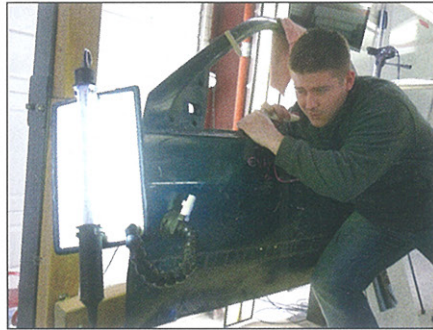
Grâce à des outils spécialement conçus pour cet effet, le débosselage peut se faire sur tous les endroits de la carrosserie, et ce en démontant un minimum d'éléments.
