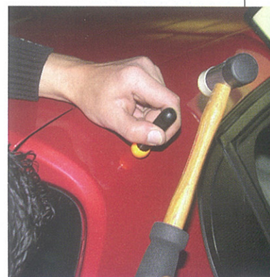
Le repoussage, avec un « pointeau » en plastique, des petits picots, provoqués avec les tiges de poussée s'avère souvent nécessaire pour une finition parfaite.
